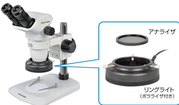
一般的なリングライト同様、顕微鏡の対物レンズ下端部に装着して使用します。
