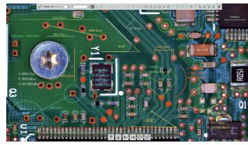
また、レイヤーモードでは較正(キャリブレーション)の情報を撮影した静止画内に保存出来ます。画像データに撮影時の較正データが保存されているので、時間が経ったあとに計測作業を行ったり、再計測を行うことができます。
